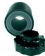
Redukcijski adapteri koriste se za prilagodbu cijevi manjih promjera u većim ulazima izolacijskih setova. Redukcijski adapter je utisnut u izolacijski sett, a prijelaz između adaptera i predizolirane cijevi zabrtvljen je termoskupljajućom završnom kapom koja je uključena u set.
