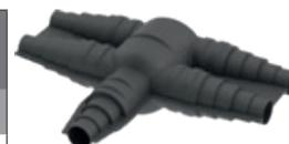
Vodonepropusni HDPE komplet za ukopanu izolaciju za duple T-spojeve između jednostrukih, dvostrukih ili četverostrukih predizoliranih cijevi. Dolazi u kompletu s mineralnom vunom iz, masom za brtvljenje, vijci i podložne pločice od nehrđajućeg čelika i upute za montažu.
